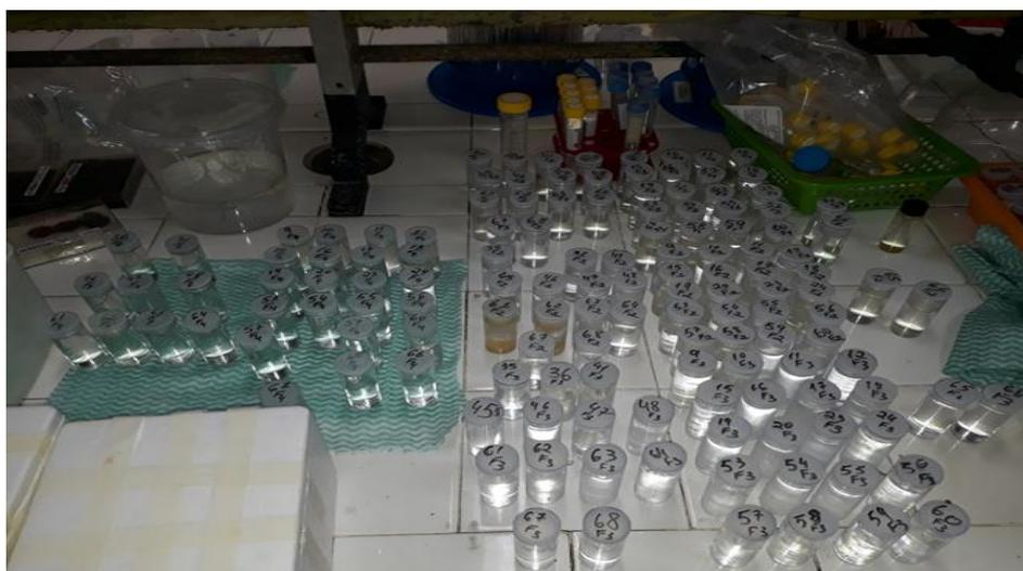
Figura 14 - Frascos contendo os extratos de metais/metaloídico referentes à extração sequencial dos ensaios de remediação de solo. Fonte: Compilação do próprio autor.
