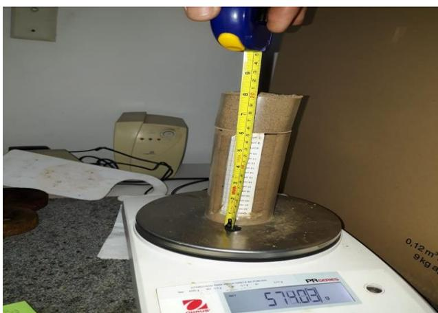
Figura 16 - Coluna de remediação de 20 cm para os ensaios de percolação de chuva artificial.
