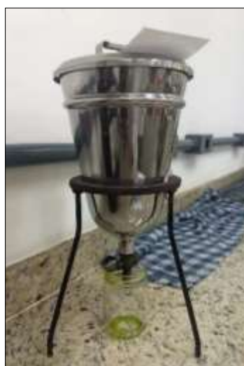
Figura 12. Extração das partes aéreas de S. concinnus por percolação, com etanol comercial (96°GL). Fonte: Acervo pessoal.
