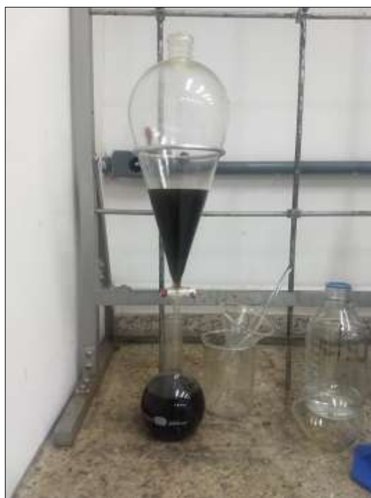
Figura 13. Partição líquido-líquido, em funil de separação, do extrato etanólico de Struthanthus concinnus . Fonte: Acervo pessoal.
