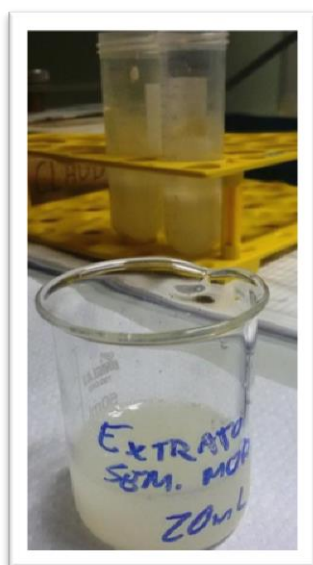
Figura 3: Extrato salino da semente de Moringa oleifera obtido após o tratamento ultrassônico e centrifugação.
