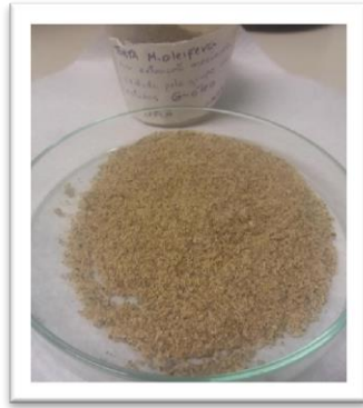
Figura 4: Torta da semente de Moringa oleifera obtida por extração mecânica, cedida pelo grupo G-ÓLEO – UFLA.
