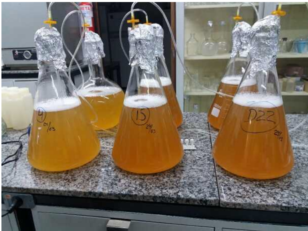
Figura 26: Produção da massa celular dos isolados em biorreatores com capacidade de 5 L com sistema de borbulhamento.
