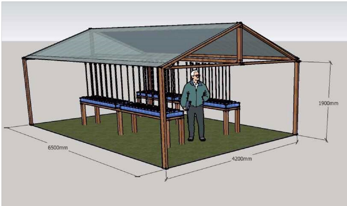
Figura 20: Esquema em 3D da seção de aquários experimentais realizado pelo programa SketchUp Pro.
