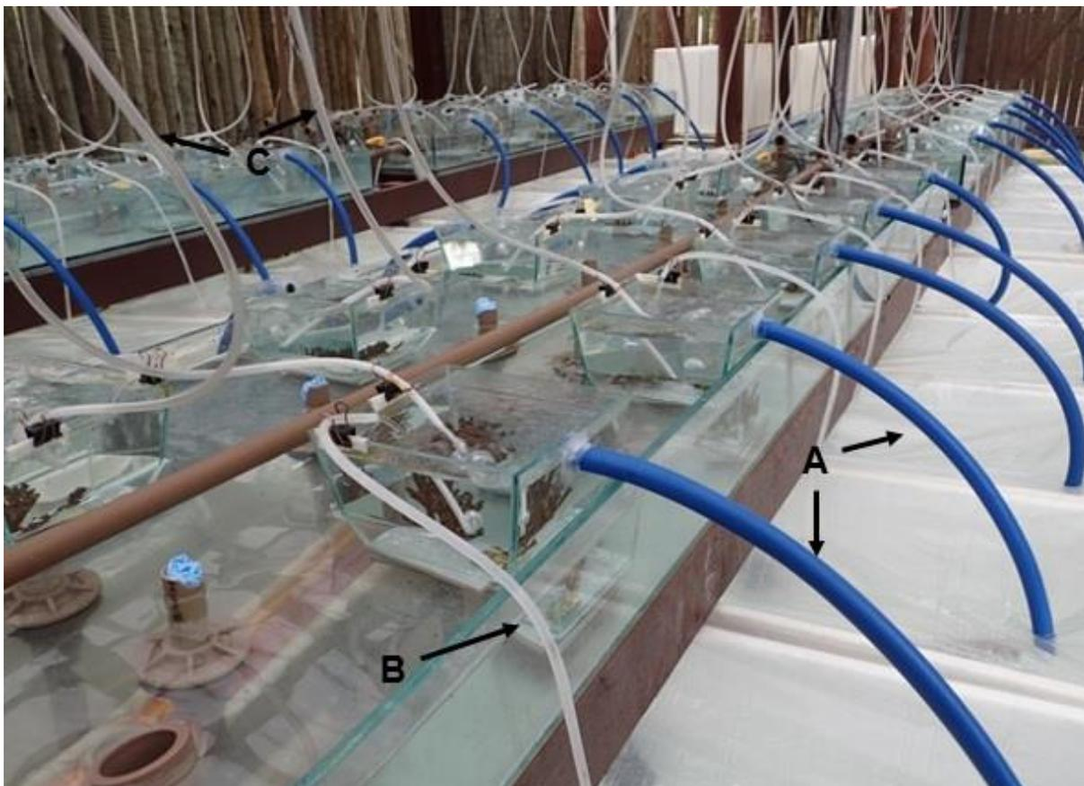
**Figura 14:** Estrutura de ligação de mangueiras em cada aquário. A, mangueiras azuis: saída de água do aquário para a caixa de 26 litros. B, mangueira de silicone abaixo: era ligada à bomba de água dentro da caixa e servia como entrada de água nos aquários. C, mangueira de silicone acima: saída de ar.
