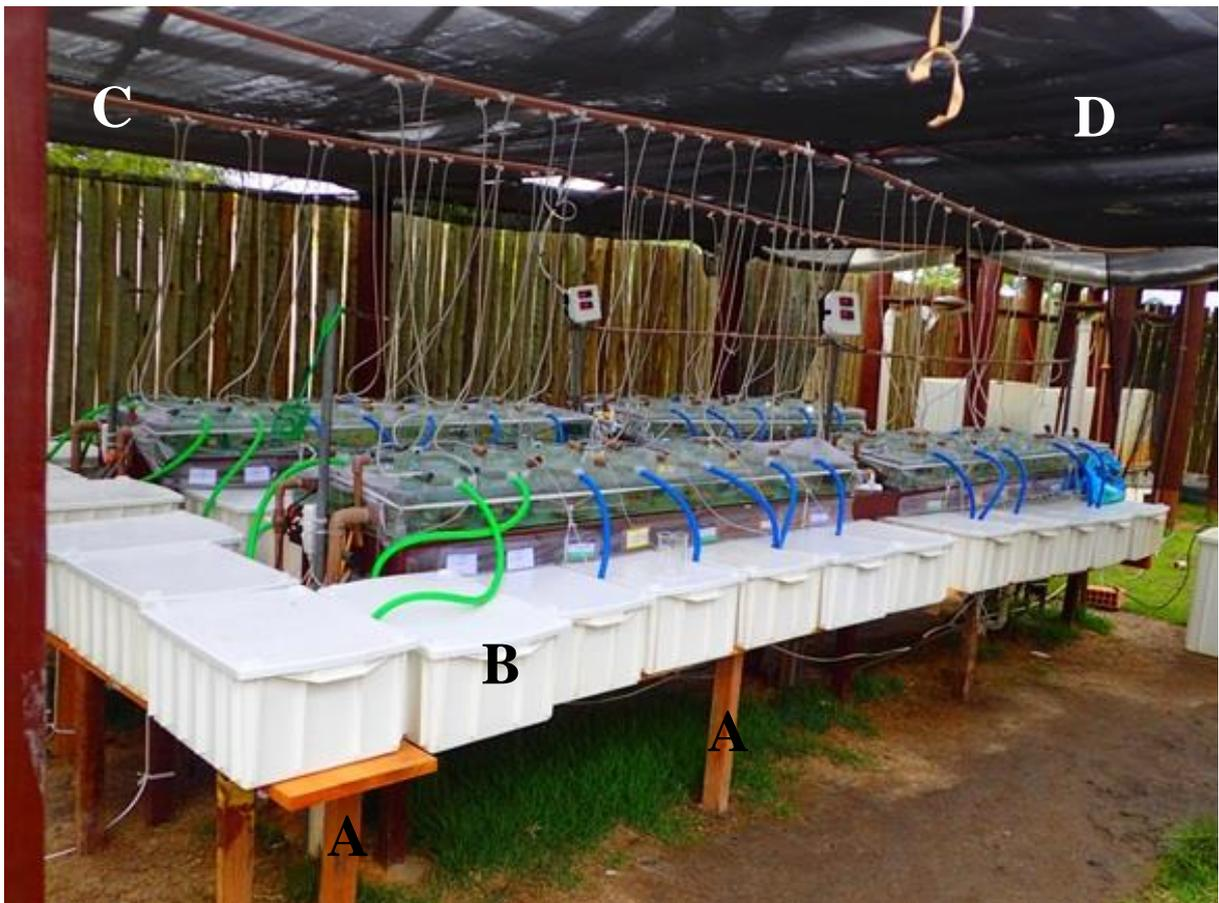
**Figura 13:** Estrutura completa utilizada na rodada experimental. A, estrutura de madeira para suporte das caixas de 26 litros. B, caixas de 26 litros utilizadas para circulação de água. C, canos de PVC para distribuição de ar para cada aquário. D, sombrite utilizado para diminuir a incidência de luz sobre o mesocosmo.
