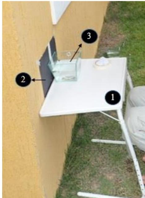
**Figura 23:** Esquema montado para tirar as fotos dos fragmentos dos corais. 1: mesa para apoio do aquário. 2: papel preto colocado atrás do aquário. 3: aquário utilizado para colocar o (s) azulejo (s) com o (s) fragmento (s) de coral.
